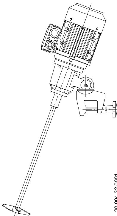
El diseño de la mordaza, con rótula orientable, nos permite una triple acción de mezcla. La fijación del agitador con el ángulo preciso para la acción de mezcla deseado es instantánea y con las tres posiciones se puede registrar y reproducir un resultado de agitación experimentado.
